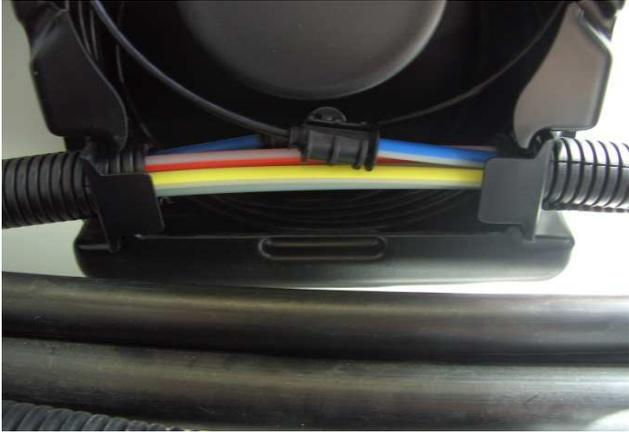
1) Das geöffnete und mit Kabel belegte speedpipe an beiden Enden mit EZA-t (siehe Montageanweisung EZA-t) verschließen. Auch unbelegte speedpipe können mit einer EZA-t verschlossen werden.
